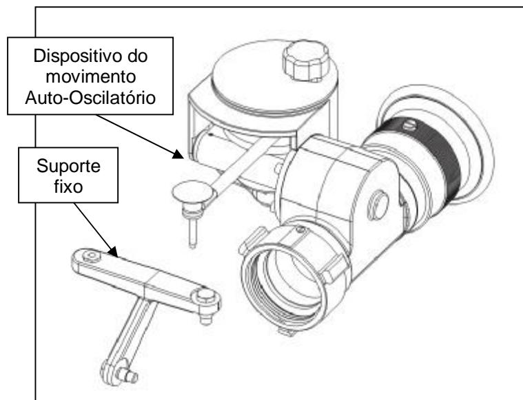
Sendo necessário apenas a fixação do suporte fixo na junta giratória do canhão monitor e consecutivamente a conexão do eixo do dispositivo Auto-Oscilatório no suporte fixo.
